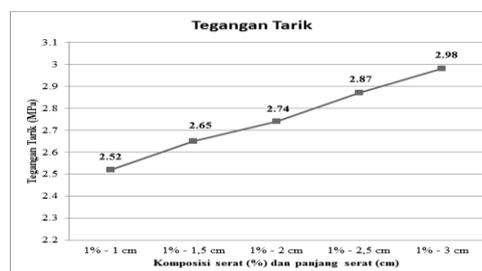
Gambar 8. Grafik hubungan antara tegangan tarik terhadap komposisi serat 1% dengan panjang serat ijuk bervariasi (1 cm, 1,5 cm, 2 cm, 2,5 cm dan 3 cm).
