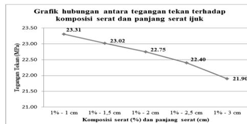
Gambar 5. Grafik hubungan antara tegangan tekan terhadap komposisi serat 1% dengan panjang serat ijuk bervariasi (1 cm, 1,5 cm, 2 cm, 2,5 cm dan 3 cm).
